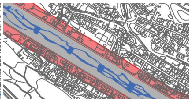
家屋倒壊等氾濫想定区域 （河岸侵食）
