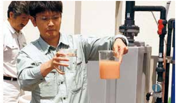
実際のろ過実験。右側がろ過前の水（濁度100以上）、左側がろ過後の水
