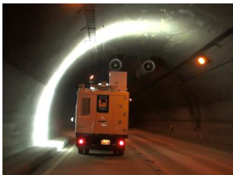
(例) 走行型高速 3D トンネル点検システム
